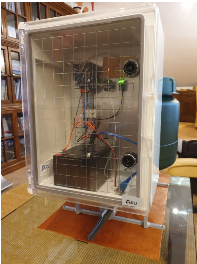
Schaltschrank mit Mikroprozessor
